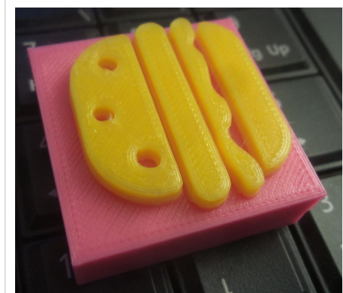
Hamburger Lego-compatible imprimé en deux couleurs en PLA avec une imprimante Felix Pro 1 [22]
