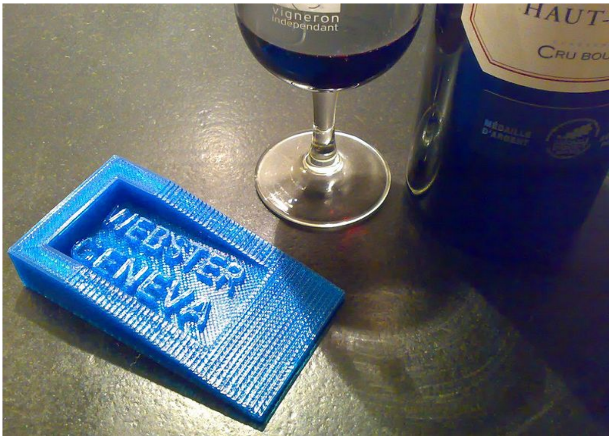
Le modèle de bloqueur de porte imprimé avec PLA (source : http://edutechwiki.unige.ch/fr/Fichier:800px-Doorstopper-webster.jpg )
